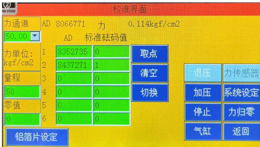
校准力值有两种方式：压传感器校准&打铝箔片校准；
